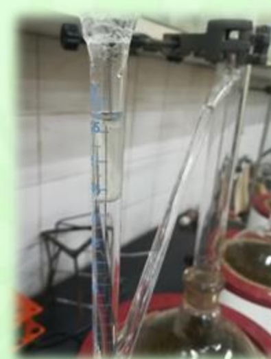
شکل ۲- اسانس گیری گیاه مورد توسط دستگاه کلونجر
