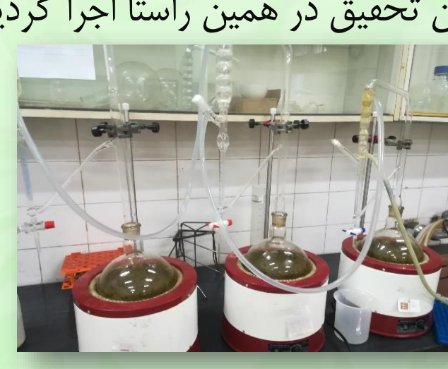
شکل ۲- اسانس گیری گیاه مورد توسط دستگاه کلونجر
